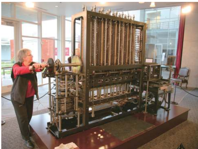
图 158 美国计算机博物馆正在运行的差分机二号
